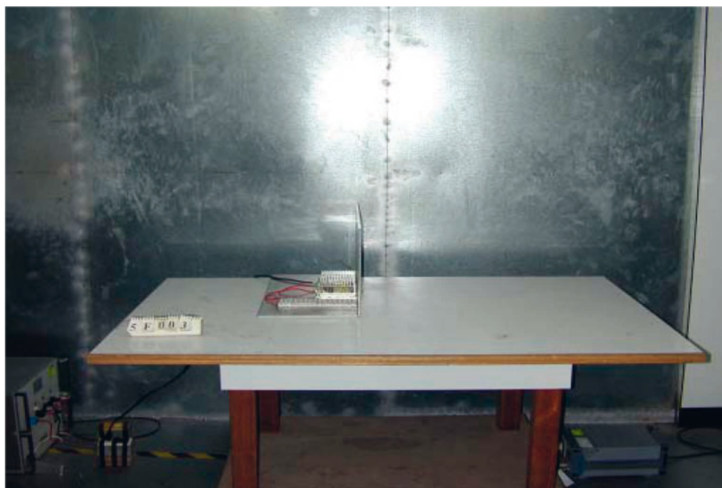
Bild 2: Messaufbau einer leitungsgebundenen Störmessung in geschirmter EMV-Kammer
