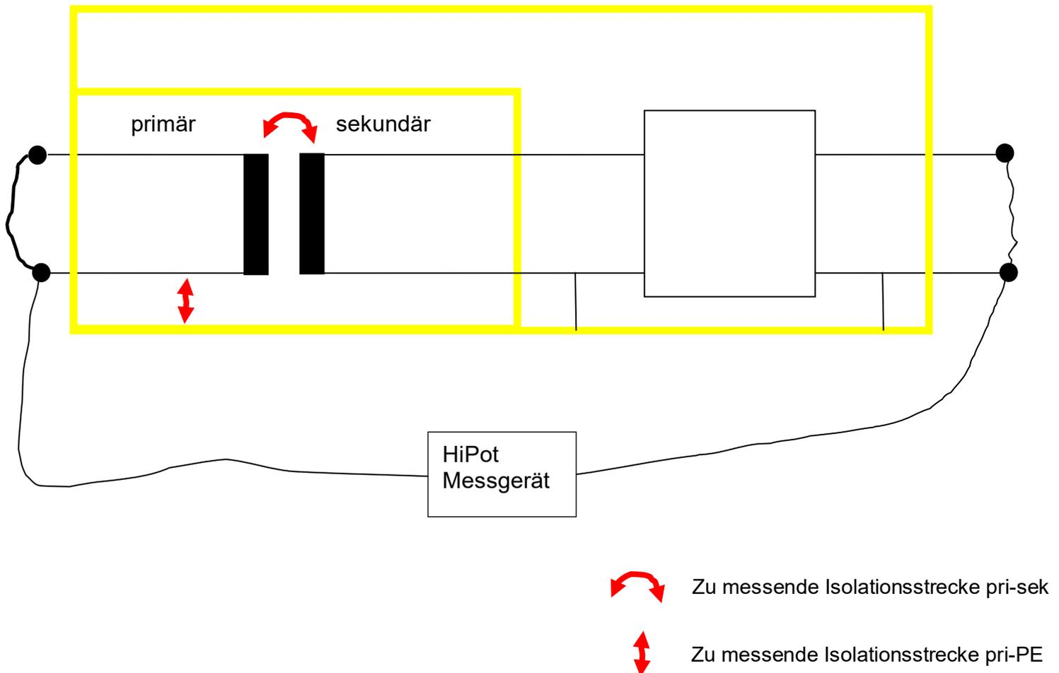
Da die Isolationsspannung pri-sek  $\gg$  prim-PE ist, kann es zu Überschlagen auf der prim-PE Strecke führen. In der Regel erlauben die hohen Toleranzen des Netzteils, den Test positiv zu bestehen, jedoch sollte im Fehlerfalle der Messaufbau entsprechend berücksichtigt werden.
