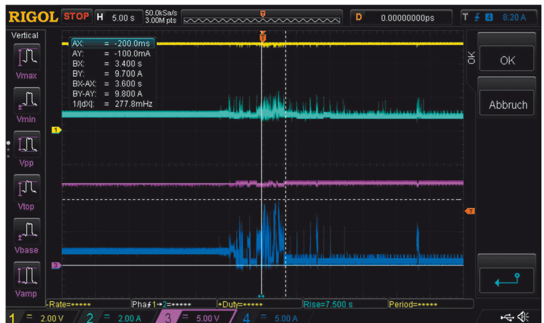
Bild 5: Hochlauf eines passenden Netzteils mit Berücksichtigung der Peakströme auf der 12-V-Strecke
