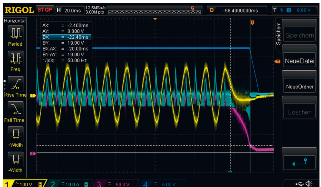
Bild 6: Spannungs- und Stromverläufe Netzteil ohne PFC 110 VAC
